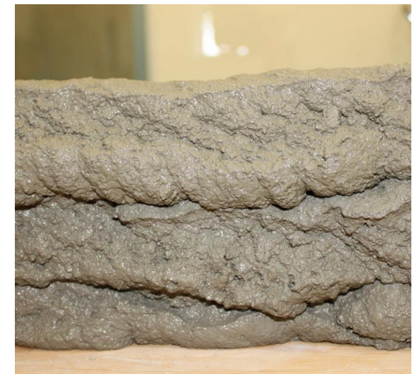
Fáze III - Test únosnosti vrstev (autor)
