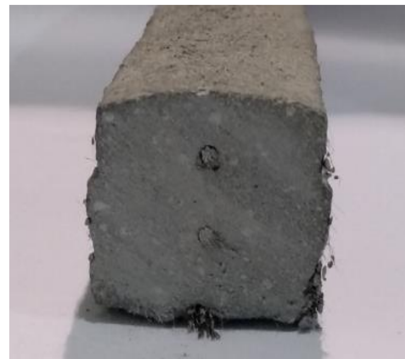
Armatura v podobě vkládaného ocelového lanka (LIM, Elsewiever [online])
